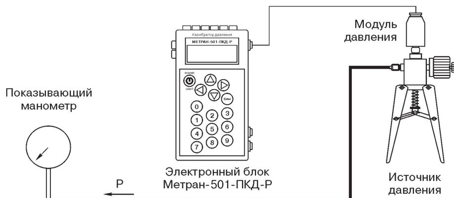
Рис.2. Калибровка показывающих манометров.
