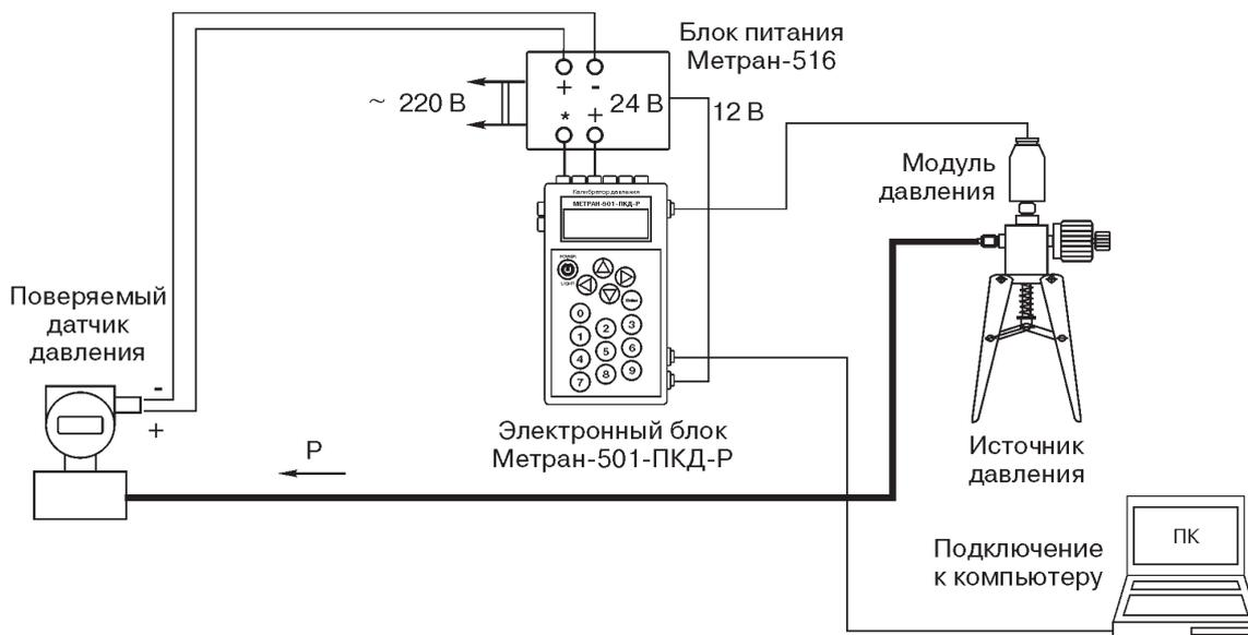
Рис.4. Поверка и калибровка измерительных преобразователей (датчиков) давления.
