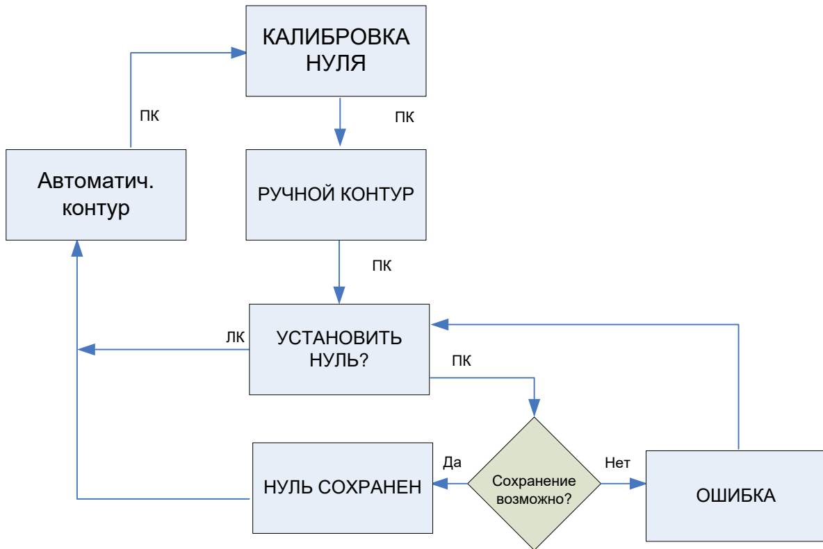
Рисунок Б.1 – Режим автоматической калибровки «нуля»
