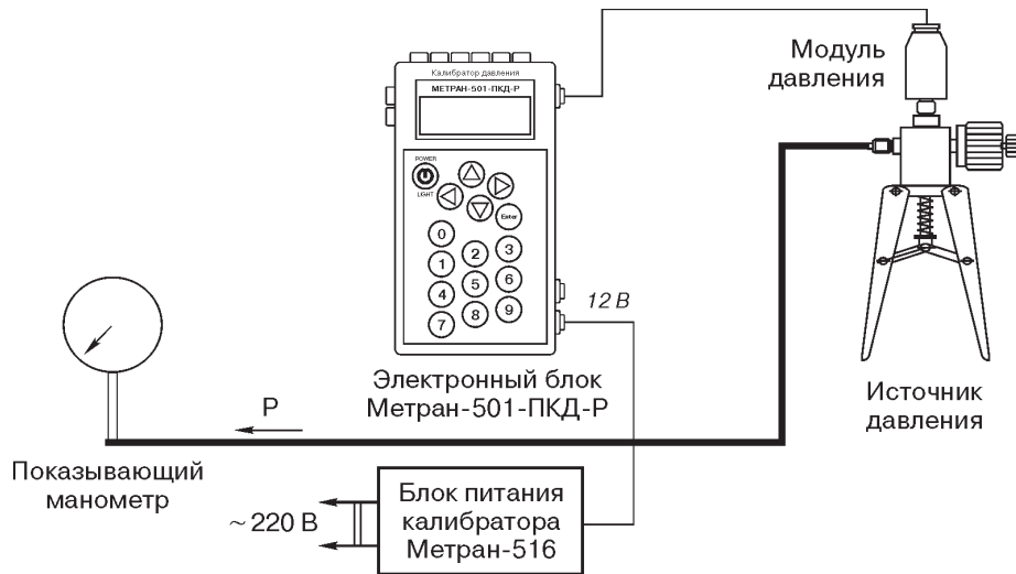
Рис. 5. Поверка и калибровка показывающих манометров.
