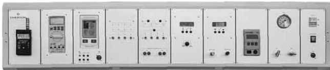
Рис.2. Пример внешнего вида надстройки стенда для поверки до 4 датчиков с автоматическим регулятором давления и набором функциональных панелей со встроенным оборудованием для ремонта датчиков.
