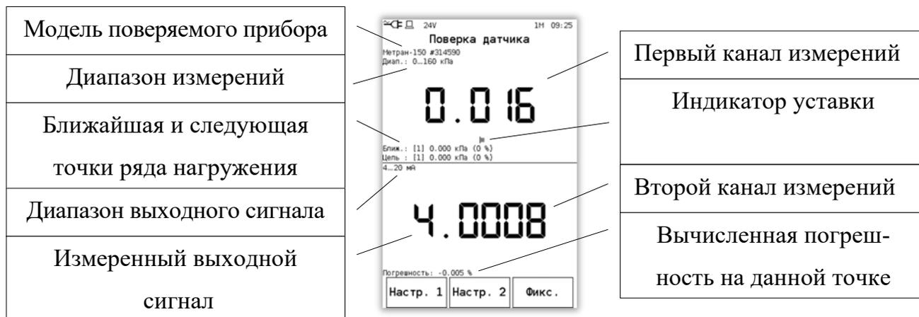
В данном режиме дисплей калибратора разделен на каналы измерения. В первом канале отображается:
