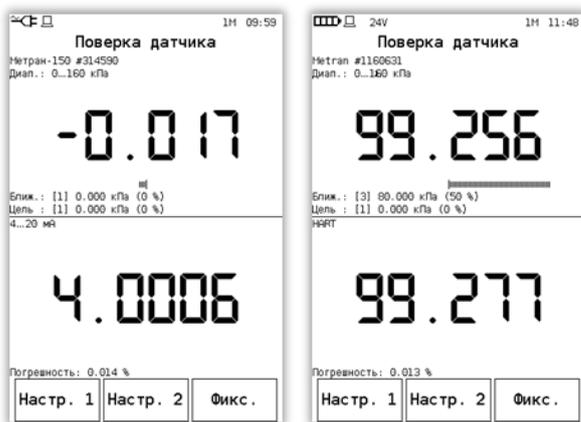
Для настройки показаний первого канала измерения (давления) следует нажать кнопку «Настр. 1». При этом калибратор переходит в меню, в котором отображается текущее измеренное давление и коэффициент усреднения:
