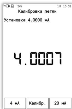
Для корректировки показаний следует нажать кнопку «Калибр.» и повторить алгоритм коррекции выходного сигнала на другой точке (20 мА).
