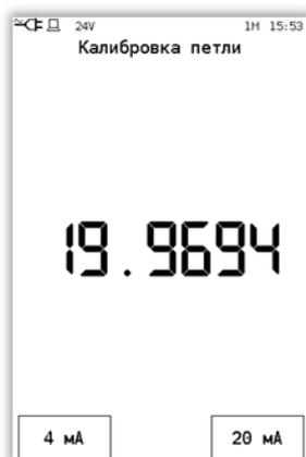
Для установки 4 мА (20 мА) следует нажать кнопку «4 мА» («20 мА»). При этом калибратор посылает команду датчику на установку соответствующего выходного токового сигнала и производит измерение выходного сигнала:
