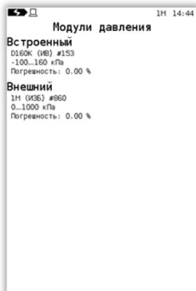
**ВНИМАНИЕ: ПРИ ПОВЕРКЕ ПНЕВМАТИЧЕСКИХ ПРЕОБРАЗОВАТЕЛЕЙ ДАВЛЕНИЯ НЕОБХОДИМО НАЛИЧИЕ ВСТРОЕННОГО И ВНЕШНЕГО МОДУЛЕЙ ДАВЛЕНИЯ!**
