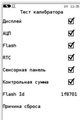
При успешном результате теста (получен корректный ответ от тестируемого узла) калибратор помечает данный параметр ✓. В случае, если тест по одному или нескольким параметрам не пройден, калибратор при включении издает звуковой сигнал (результаты тестов возможно просмотреть в данном разделе меню).
