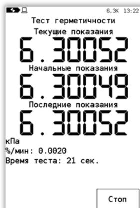
При этом на экране калибратора отображается результат теста (разность между начальными и текущими показаниями в единицу прошедшего времени).
