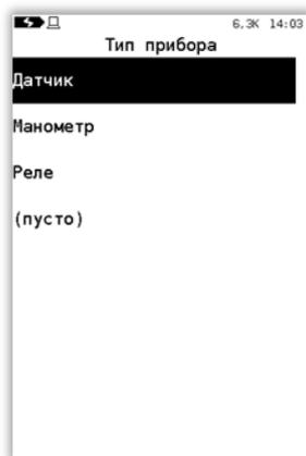
После выбора типа прибора станут доступны соответствующие поля ввода данных. Далее следует ввести данные поверяемого прибора (см. п.п. 2.6.1.2 – 2.6.1.4).
