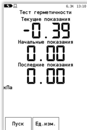
Воспроизвести давление, равное ВПИ поверяемого прибора, выдержать его под давлением в течение 3-5 минут для стабилизации термодинамических процессов.
