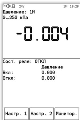
Для настройки канала измерения давления следует нажать кнопку «Настр. 1» (см. 2.7.3.1), для сброса зафиксированных значений давления, при котором произошло срабатывание реле следует нажать кнопку «Настр. 2», выбрать команду «Сброс»:
