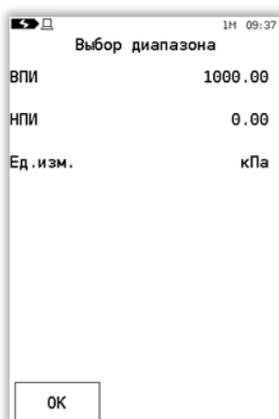
Для настройки модуля давления следует подключить его пневматический выход к эталону давления, установить атмосферное давление и произвести регулировку нуля, выбрав соответствующую команду:
