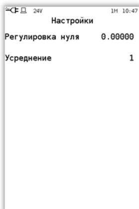
Для корректировки нуля следует выбрать «Регулировка нуля». При этом для модулей избыточного и давления-разрежения следует сперва разгрузить давление до атмосферного, стереть текущее показание давления в строке ввода, нажав кнопку «С», ввести в числовое поле 0 и нажать кнопку «ОК». Для модулей абсолютного давления корректировка показаний давления производится в меню «Сервис» - «Калибровка» (см. 2.9.9).
