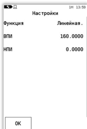
и произвести настройку параметров преобразования: функция преобразования (см. 2.7.2.3) и пределы преобразования (ВПИ, НПИ).
