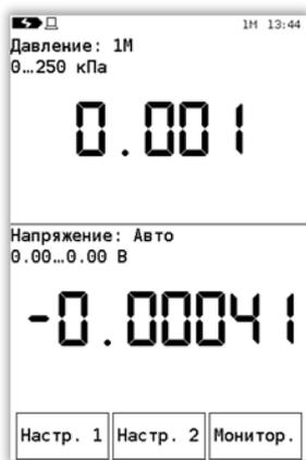
Для настройки канала измерения давления следует нажать кнопку «Настр. 1» (см. 2.7.3.1), для настройки канала измерения напряжения следует нажать кнопку «Настр. 2»:
