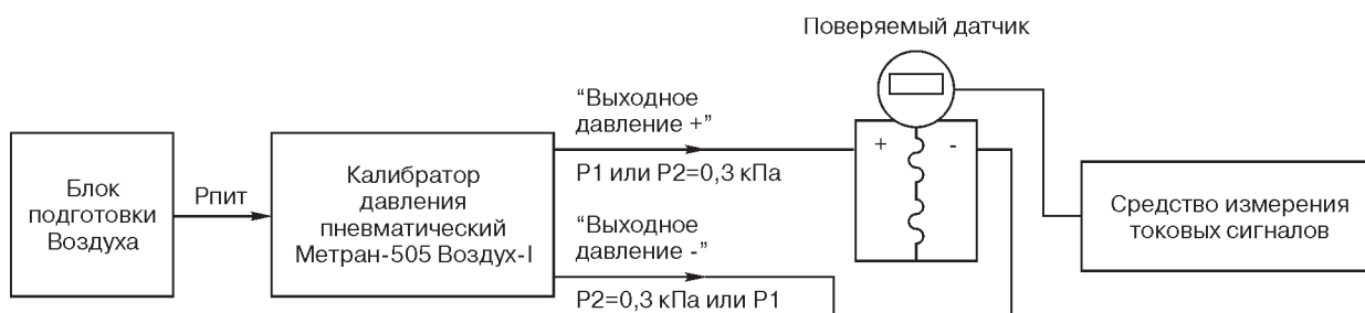
Рис.5. Схема подключения калибратора Метран-505 Воздух-I при поверке датчиков разности давлений с использованием БОД.
