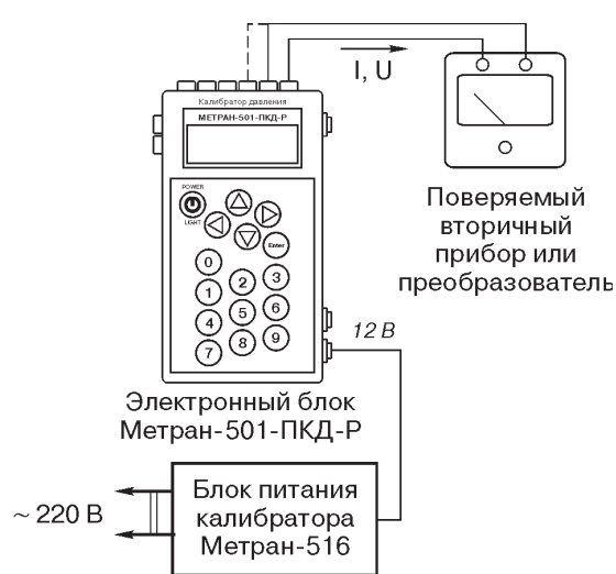
Рис.7. Проверка и калибровка регистраторов и т.п.
