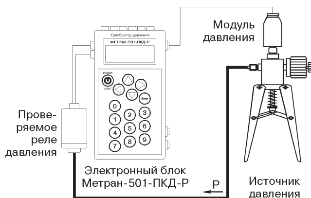
Рис. 3. Проверка реле давления.
