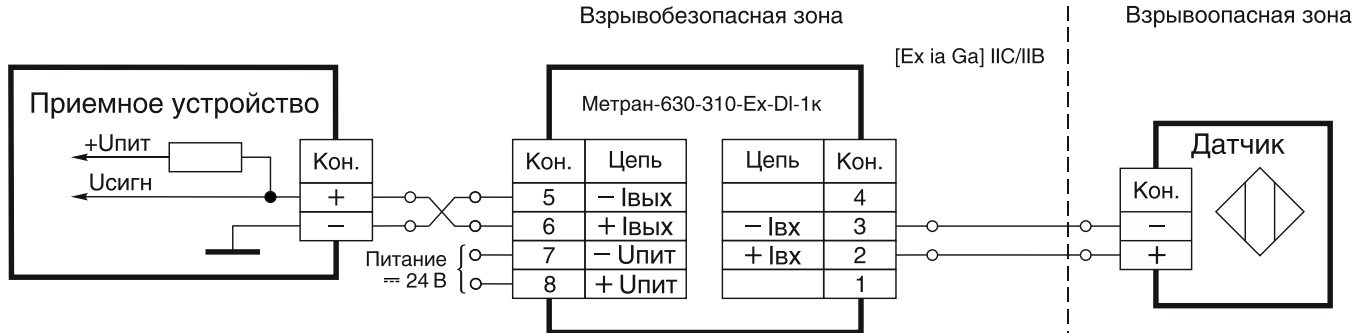
Рисунок Б.2 — Схема подключения барьера Метран-630-310-Ex-DI-1к к датчику с выходным сигналом по стандарту NAMUR
