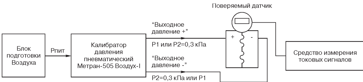
Рис.5. Схема подключения калибратора Метран-505 Воздух-I при поверке датчиков разности давлений с использованием БОД.
