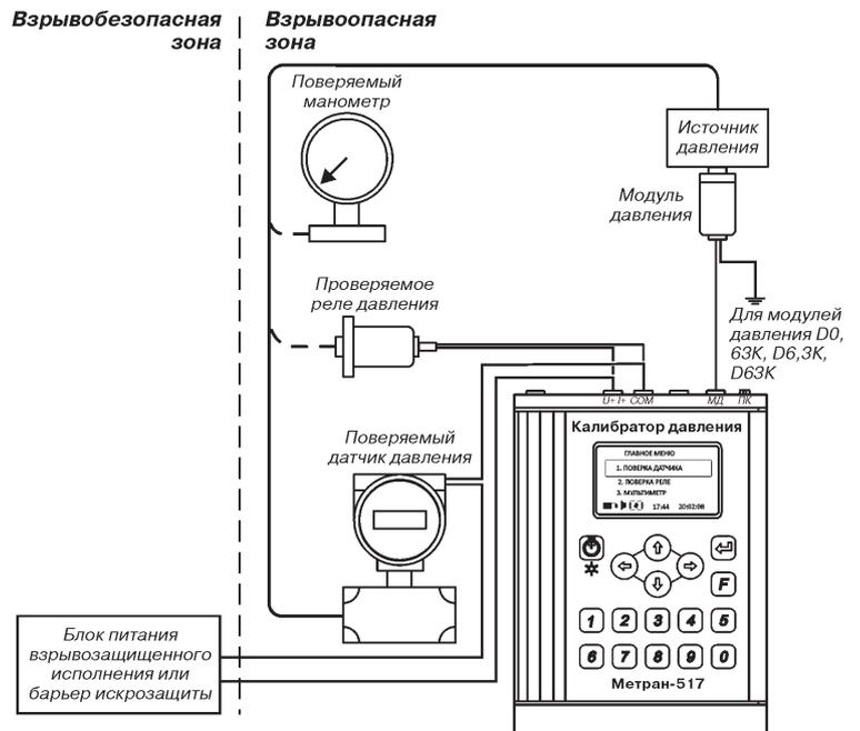
Рис.2. Схема подключения поверяемых приборов во взрывоопасной зоне.
