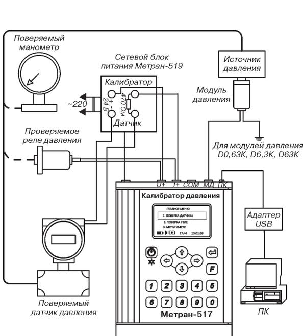
Рис.1. Схема подключения поверяемых приборов во взрывобезопасной зоне.
