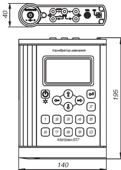
**Рис.1. Электронный блок.**
