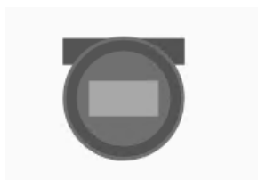
Рис. 78 Пиктограмма полевого устройства при отсутствии в приложении описания устройства в EDD формате
