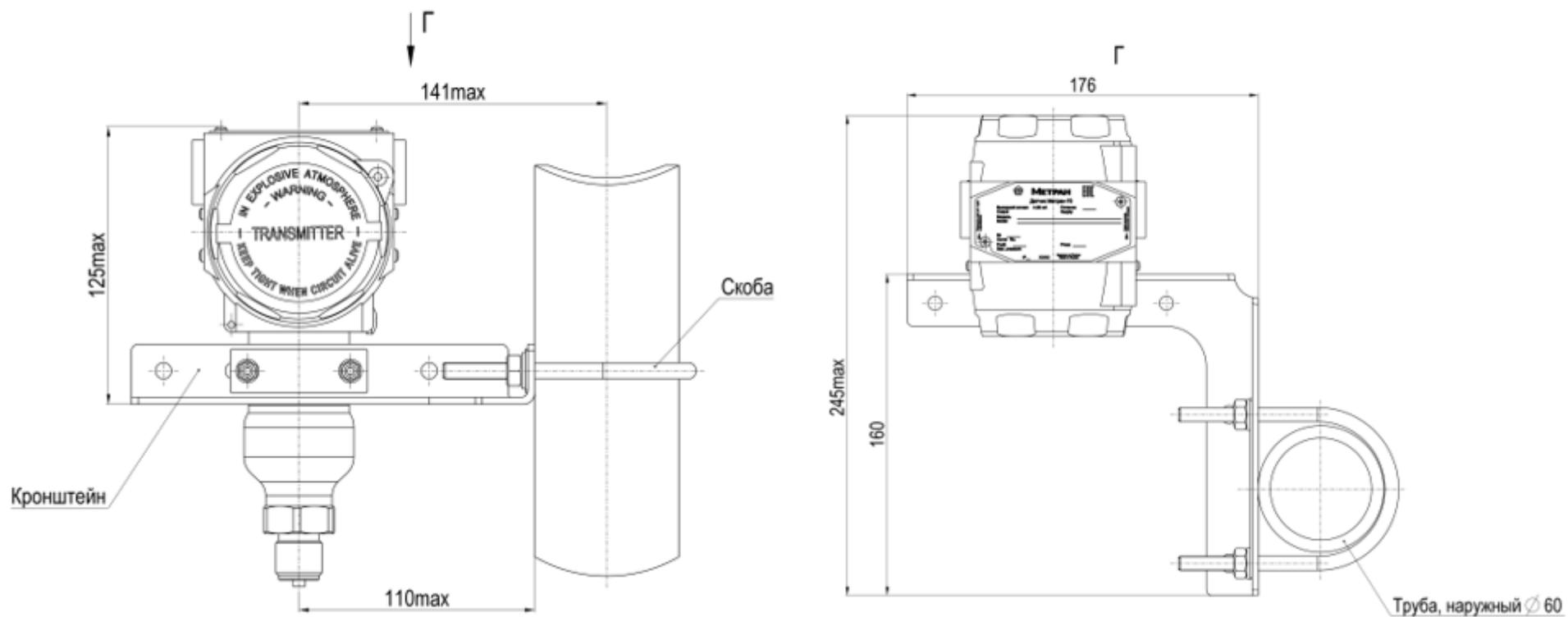
Рисунок Ж.13 – Датчики моделей 75РА/75РГ с установленным монтажным кронштейном В4
