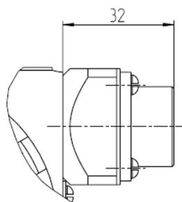
Разъём DIN 43650 (код SC5)
