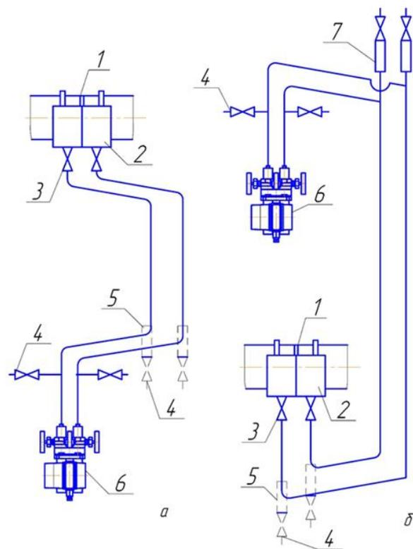
Рисунок 3 – Схема соединительных линий при измерении расхода пара
