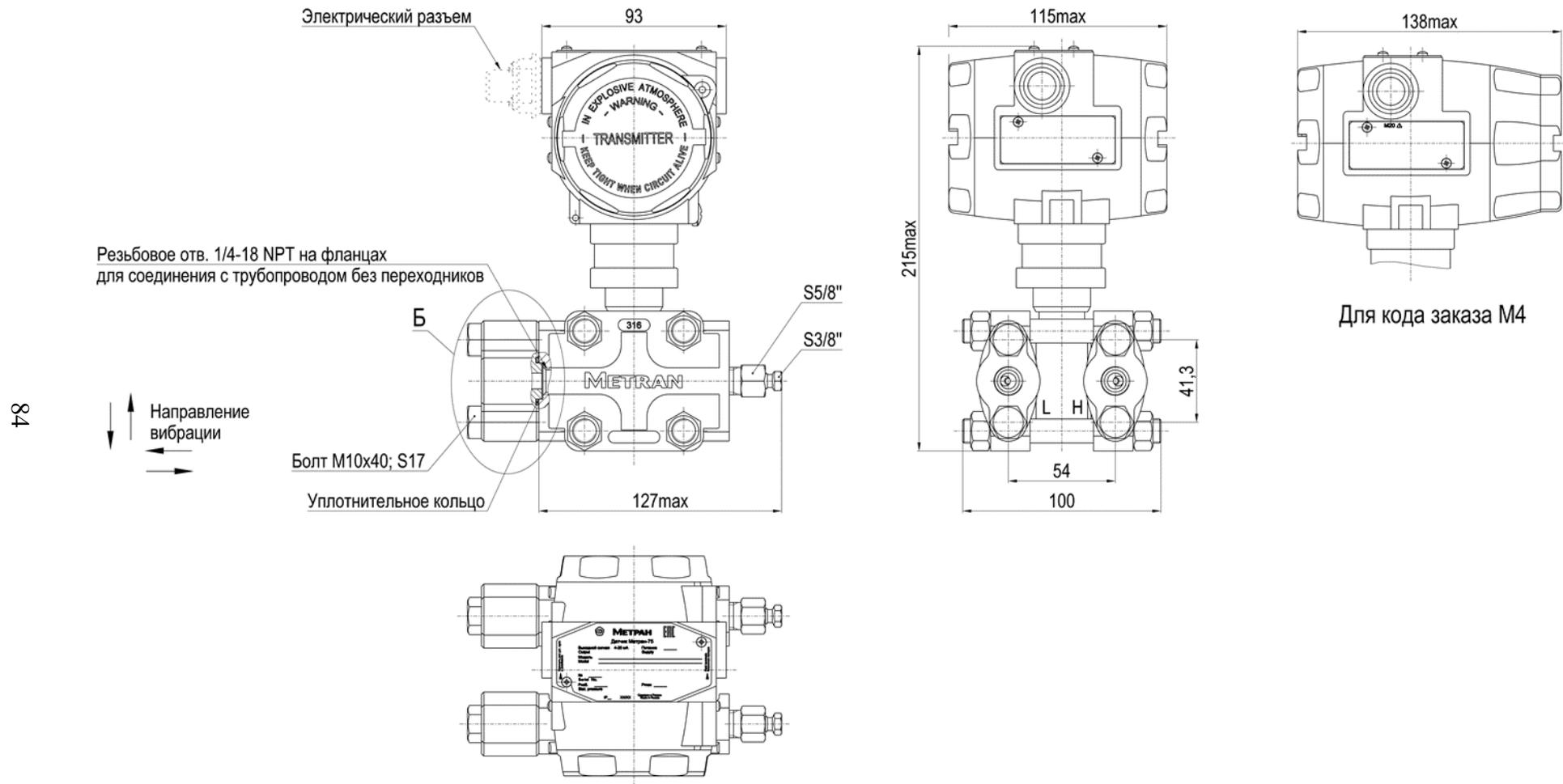
Н и L – маркировка подвода давления на корпусе датчика: Н соответствует большему давлению; L соответствует меньшему давлению.
