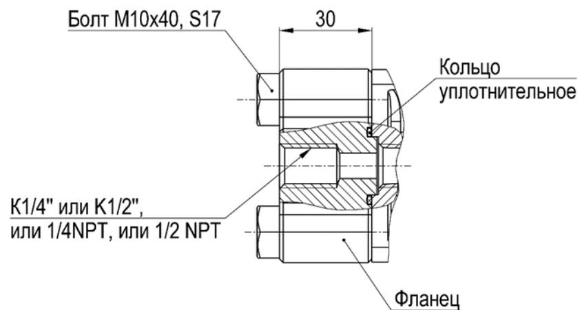
Рисунок Ж.5 – монтажные части коды D1-D4
