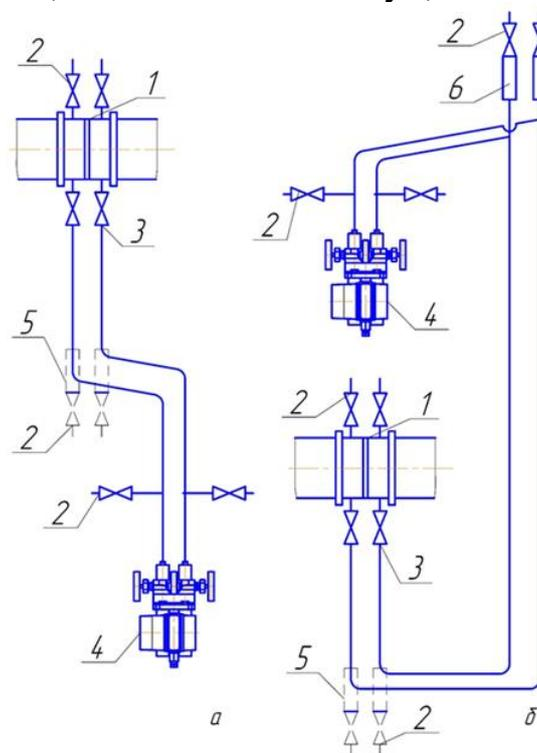
Рисунок 4 – Схема соединительных линий при измерении расхода жидкости
