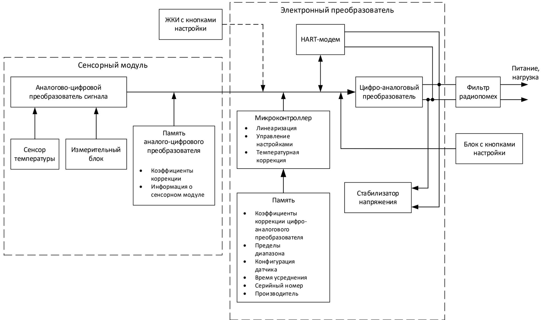
Рисунок 1 – Функциональная блок-схема
