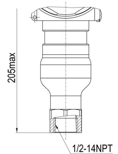
Для соединения с процессом код 2G
