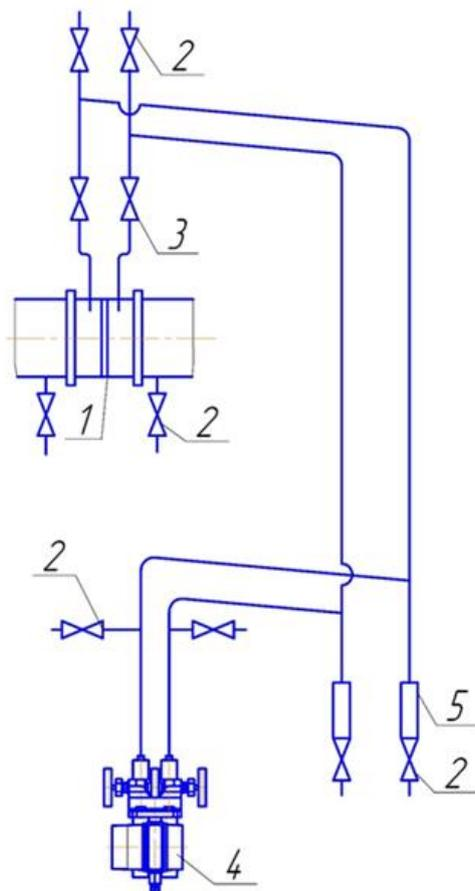
Рисунок 2 – Схема соединительных линий при измерении расхода газа
