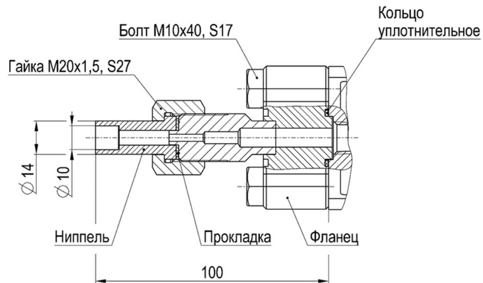
Рисунок Ж.6 – монтажные части коды D5
