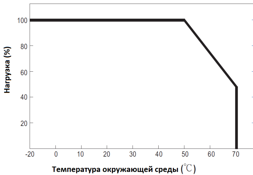
Рисунок 2 – Режим работы Источника в диапазоне рабочих температур
