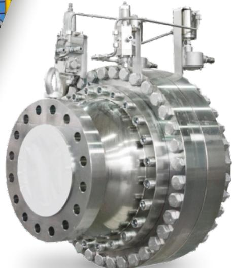
Регуляторы давления газа Метран серии ФЛ предназначены для снижения и автоматического поддержания давления газа на выходе регулятора независимо от отбора газа потребителями и колебания давления на входе. Регуляторы работают без использования постороннего источника энергии, это устройства с осевым потоком газа, одним седлом и уравновешенным затвором. Малое количество деталей и модульная конструкция позволяет гибко подходить к опциональности заказа.
