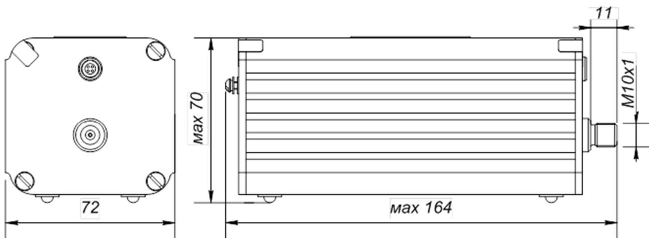
Рисунок Б.3 – Конструкция модулей давления D0,63К, D6,3К и D63К
