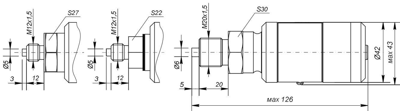
Рисунок Б.2 – Варианты конструкции модулей давления Взрывозащищенного исполнения и Общепромышленного исполнения с кодом исполнения О «Обезжиривание» (за исключением модулей давления D0,63К, D6,3К и D63К)
