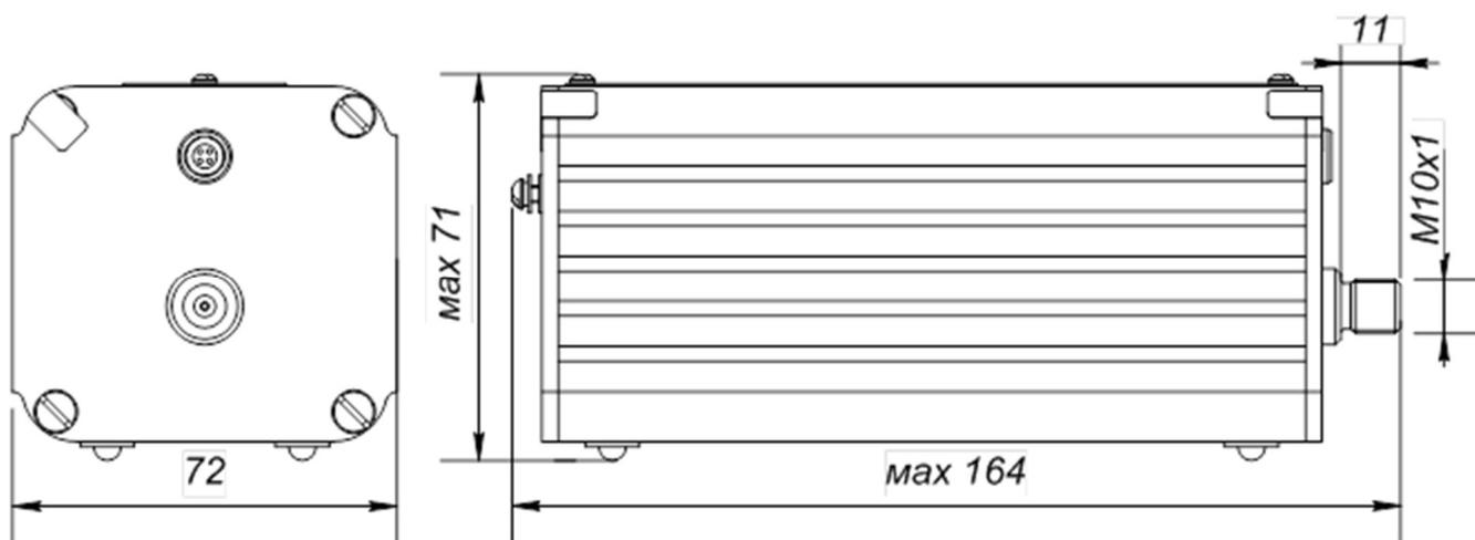
Рисунок Б.4 – Конструкция модулей давления D0,63К, D6,3К и D63К
