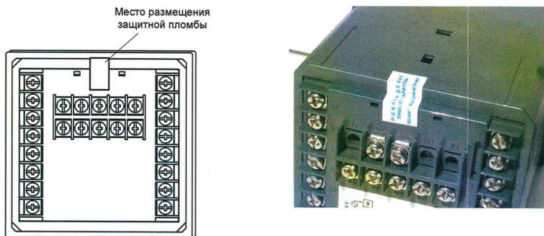
Рисунок 2 – Схема и внешний вид пломбировки регулятора от несанкционированного доступа.
