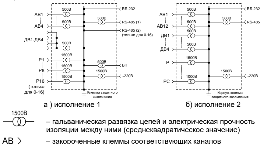
Рисунок 1.2. Схема гальванической изоляции регистраторов.
