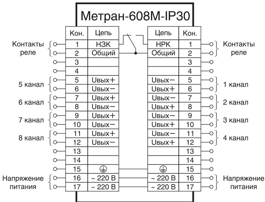
Рисунок Б.2 — Схема подключения БПП
