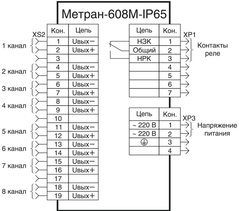
Рисунок Б.1 — Схема подключения БПП
