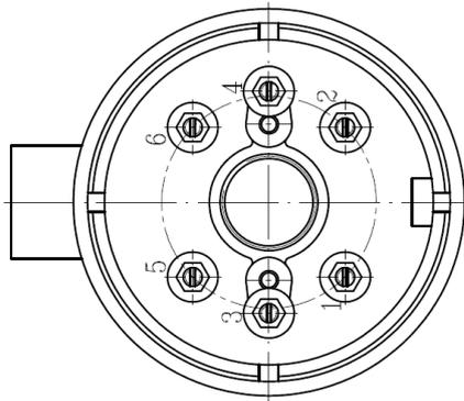
Рисунок X.6 – Размещение контактов ТП с соединительной головкой П
