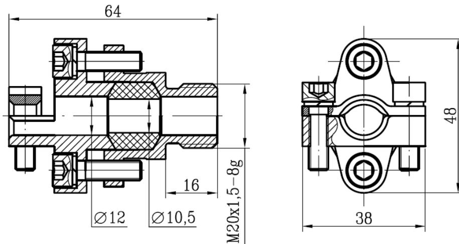
Рисунок Л.4 – Ввод кабельный для монтажа бронированного кабеля (БК)
