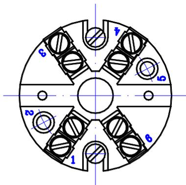
Рисунок X.3 – Размещение контактов ТП с соединительной головкой А1, А2, А3, А5, А6, С1
