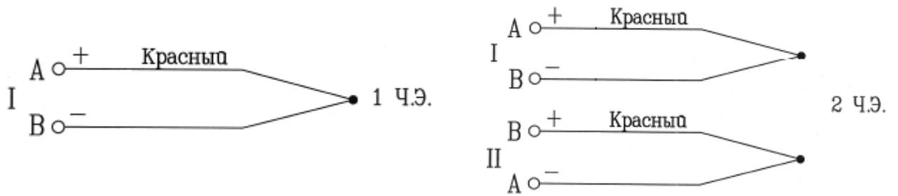
Рисунок X.7 – Двухпроводная схема ТП с одним ЧЭ с соединительной головкой А4
