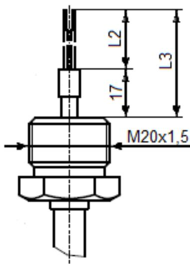
Рисунок К.7 – Исполнение ТП без соединительной головки
