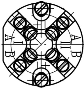
Рисунок X.9 – Размещение контактов ТП с соединительной головкой А4
