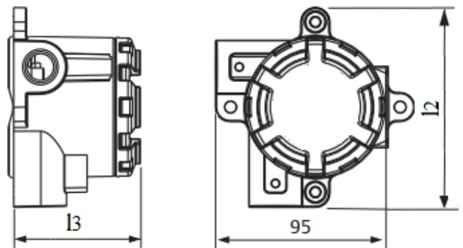
Рисунок К.6 – Соединительная головка А6
