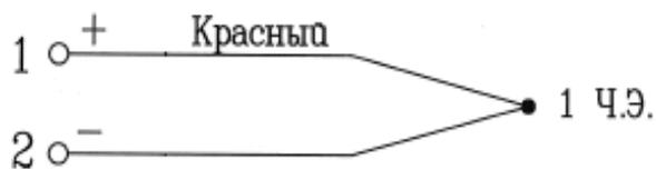
Рисунок X.4 – Двухпроводная схема ТП с одним ЧЭ с соединительной головкой П1
