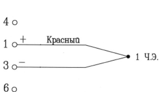
Рисунок X.1 – Двухпроводная схема с одним ЧЭ
