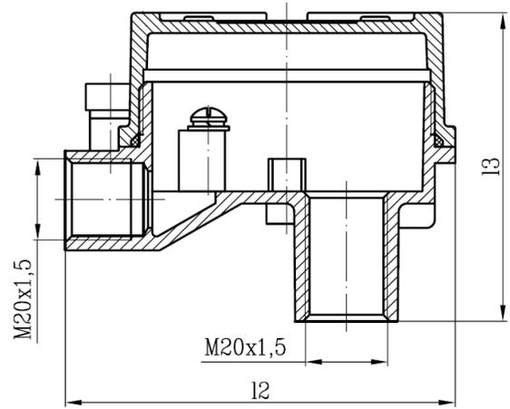
Рисунок К.2 – Соединительная головка А2, А3
