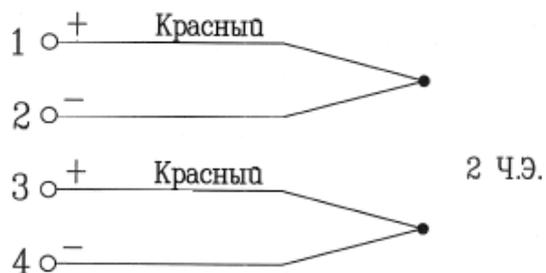
Рисунок X.5 – Двухпроводная схема ТП с двумя ЧЭ с соединительной головкой П1
