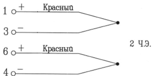
Рисунок X.2 – Двухпроводная схема с двумя ЧЭ
