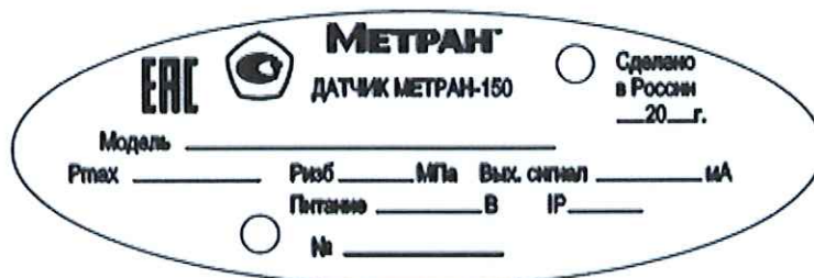
Рисунок 2 – Место нанесения знака утверждения типа и заводского номера
