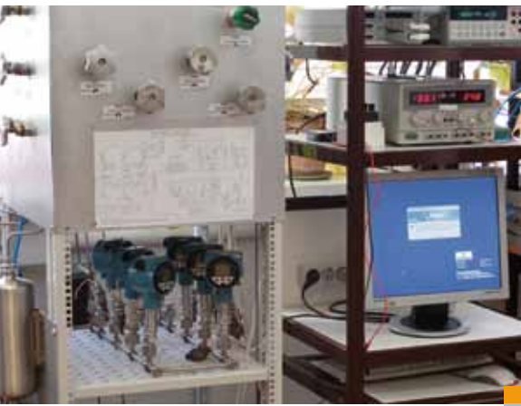
Испытание датчиков давления на безотказность, ГИЦ
