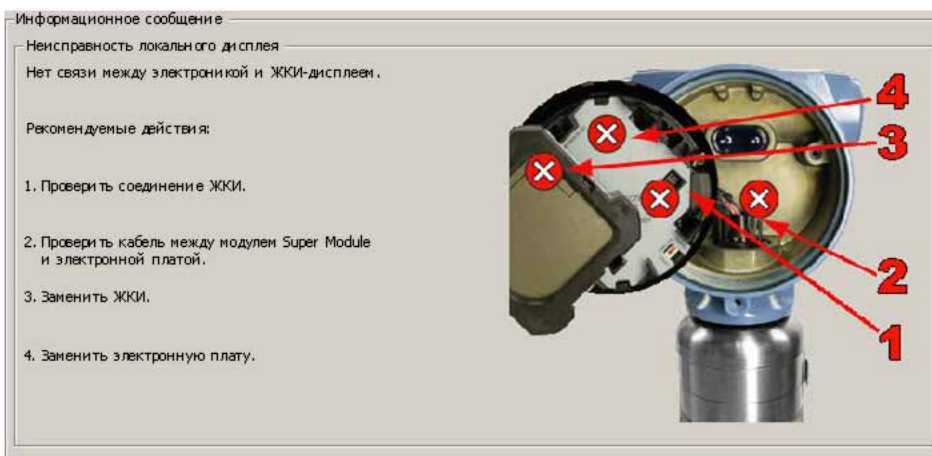
Информационные панели устройств показывают операторам, в чем заключается проблема и как ее решать
