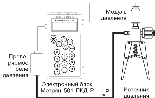
Рис. 3. Проверка реле давления.
