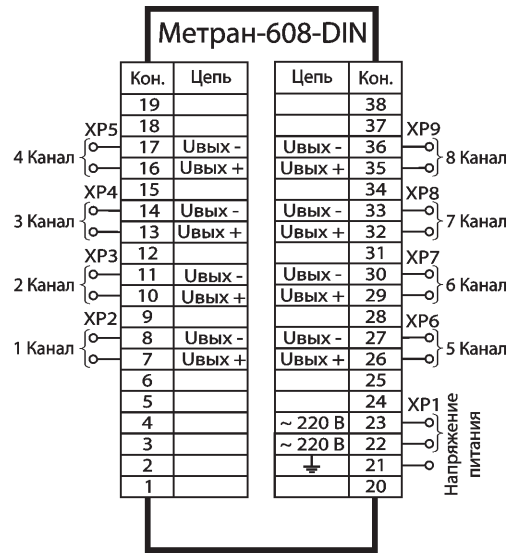
Рис.7. Схема подключения блоков Метран-608 (исполнение DIN).
