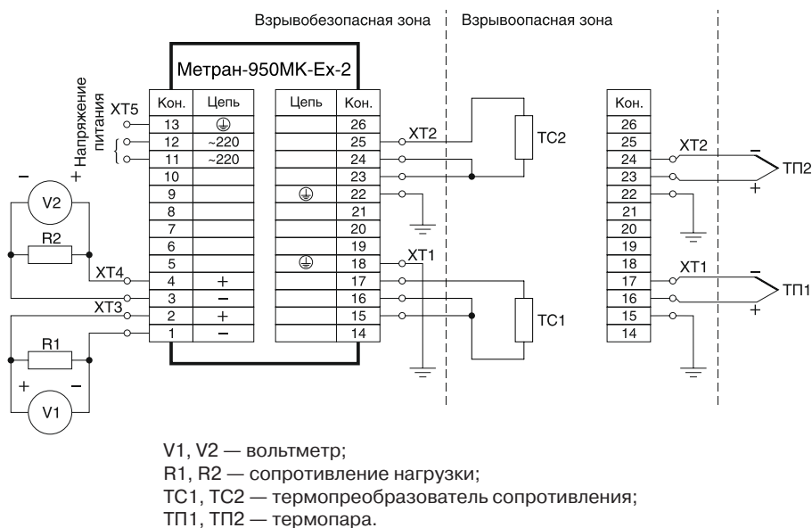
Рис. 4. Подключение двухканального Метран-950МК-Ex при измерении сигналов от термопар, термопреобразователей сопротивления с выходным сигналом 4...20 мА
