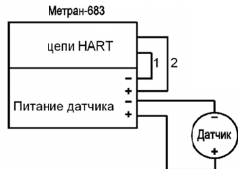
Рис. 4. Схема подключения с использованием встроенного источника питания. Для использования данного варианта необходимо подключить перемычки 1 и 2
